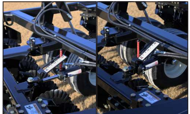
Fig. 43 Toolbar Angle: 0^\circ/14^\circ
